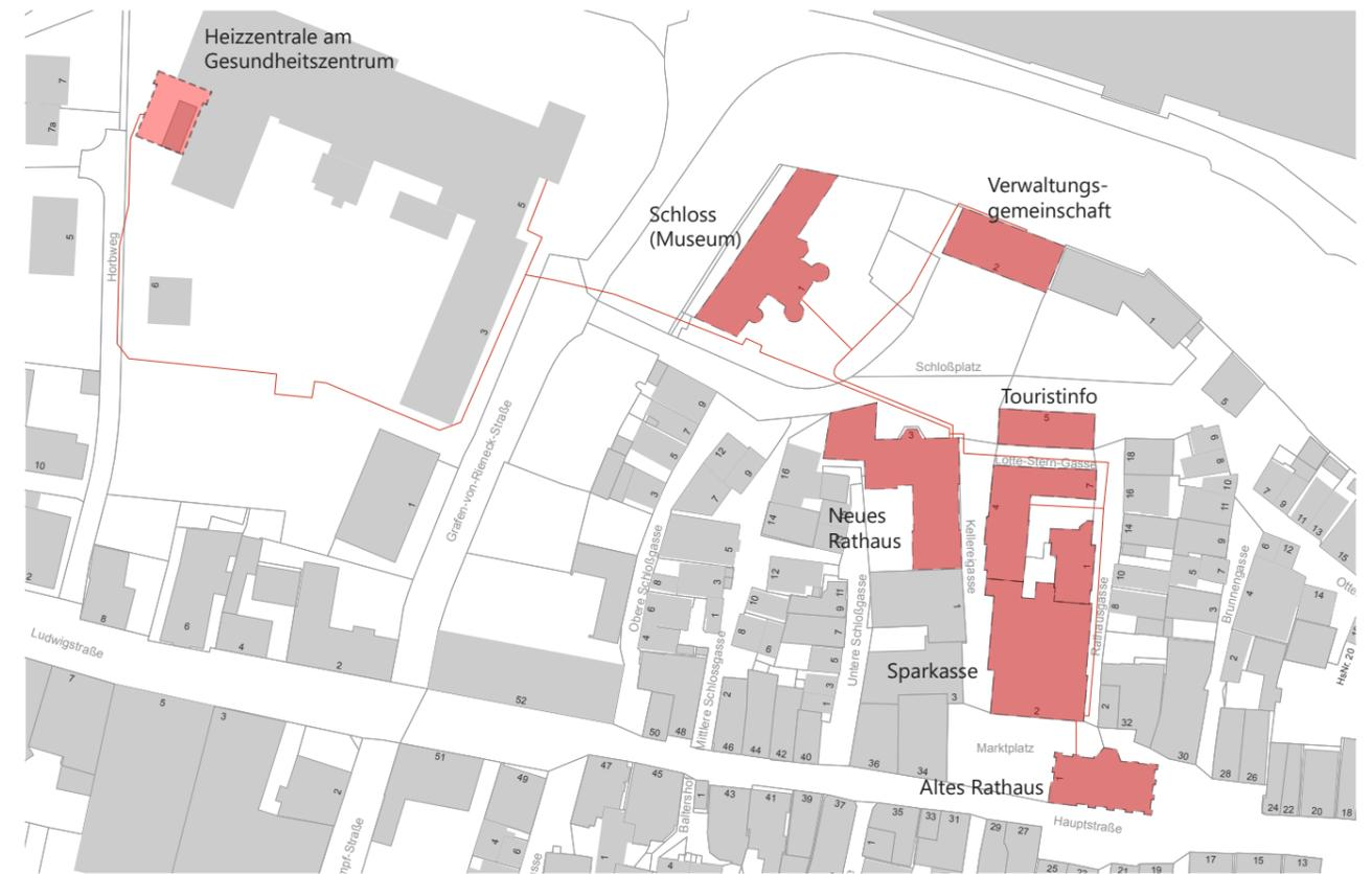
Abb. 023: Nahwärmeverbund-Altstadt, Trassenplan; eigene Darstellung auf Grundlage Umweltbericht Lohr a. Main
