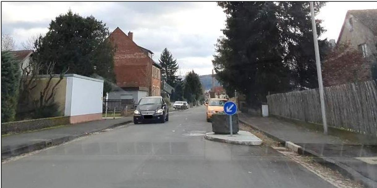
Abbildung 70: Alternierende Geschwindigkeitsdämpfung in der Rodenbacher Straße
