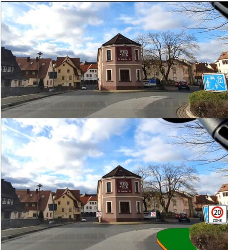
Abbildung 72: Konzeptskizze K 14: Reduzierung des Straßenquerschnitts
