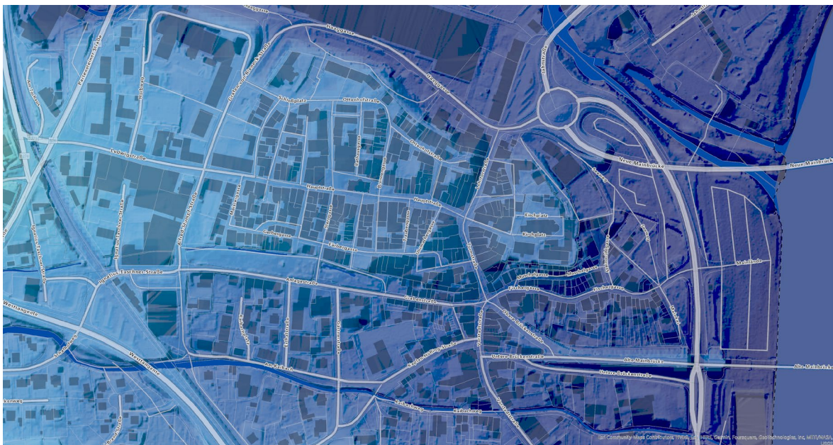
Abbildung 59: Detailansicht Themenkarte "Nächtliche Kaltluftproduktion und Kaltlufttransport nach 8Std. Simulationszeit" - Bereich "Altstadt". Am Ende der Simulationsnacht liegt die Kaltluftschichtdicke im Innenstadtbereich bei rd. 120 – 130m.
