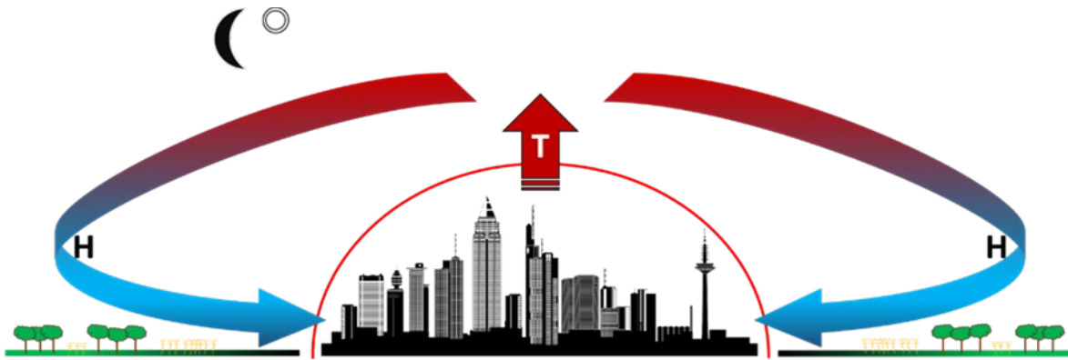
Abbildung 8: Darstellung eines Flurwindsystems am Beispiel des Stadt-Umland-Windsystems. Während einer strahlungsarmen Nacht steigen die wärmeren "Stadtluft"-Massen auf (geringere Dichte) um nach Abkühlung (höhere Dichte) wieder abzusinken. Zusammen mit den nach Sonnenuntergang entstehenden Kaltluftmassen des ruderalen Raums etabliert sich so ein sensibles Flurwindsystem (Sogwirkung durch den Luftdruckgegensatz).
