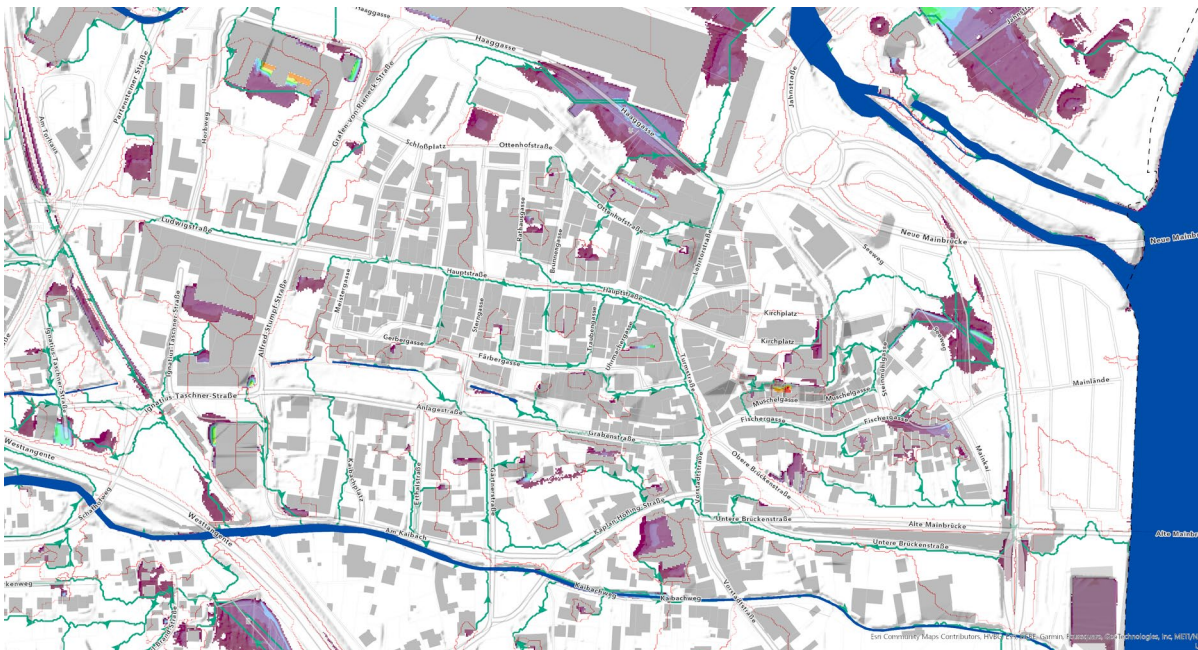
Abbildung 37: Detailansicht Themenkarte "Starkregengefahrenkarte | Tiefendarstellung" - Bereich "Altstadt". Die meisten im Innenstadtbereich identifizierten BlueSpots weisen geringe Tiefen von bis maximal 0,75\text{m} auf. Größere Tiefen stellen sich punktuell im Zusammenhang mit der vorliegenden Bebauung ein, bspw. im Eingangsbereich des „Klinikums“, nördlich der „Muschelgasse“ oder östlich der „Uhrmachergasse“ ein.
