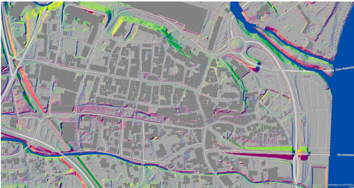
Abbildung 28: Detailansicht Themenkarte "Hangneigung und Hangrichtung" - Bereich "Altstadt". Der Innenstadtraum zeigt sich relativ flach mit Hangneigungen < 5%. Steilere, aber kleinflächigere Geländebereiche finden sich in und um die vegetationsbestandenen Bereiche südlich der „Haaggasse“ sowie nördlich der „Anlagestraße“ und entlang des Bahndamms sowie der Fließgewässer.
