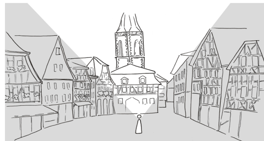
Abbildung 38: Prinzip des SkyView Factors
